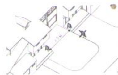
Возле одного входа может размещаться не более одного штендера. Расстояние между несколькими штендерами должно составлять не менее 5 м
