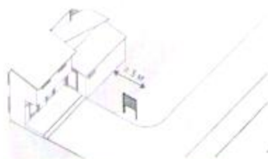
Расстояние от информационного стенда до фасада ближайшего здания должно составлять не менее 5 м (за исключением стендов, относящихся к этому зданию)
