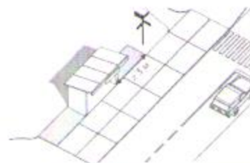
Расстояние от навигационного указателя до остановки общественного транспорта — не менее 3 м. При этом их взаимное расположение должно быть параллельно дороге
