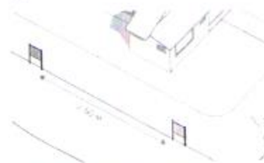
Информационный стенд следует размещать на расстоянии не менее 60 м от других информационных конструкций (при этом в зоне 1 расстояние должно составлять не менее 120 м)
