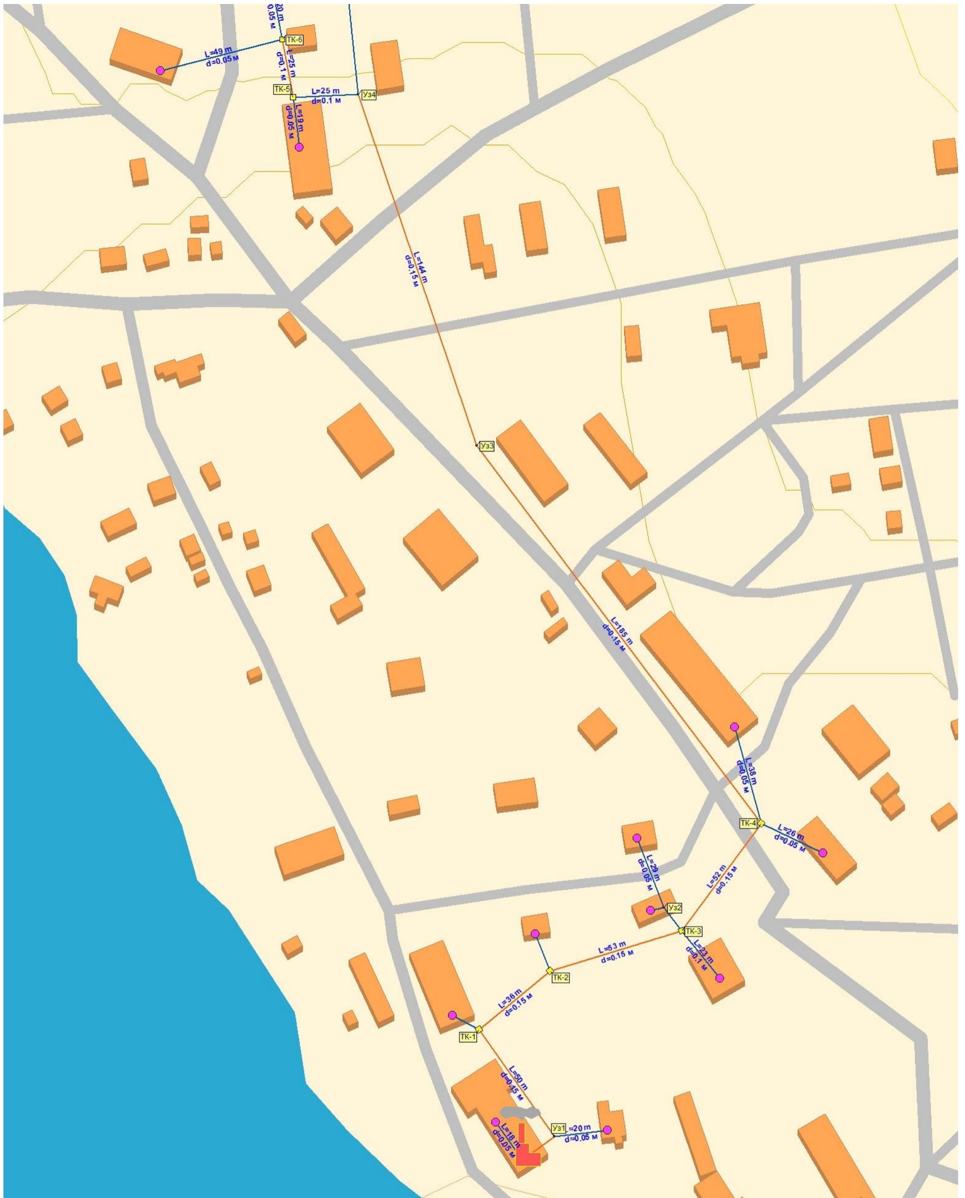
Рисунок 5.4.1. Графическое изображение участков тепловых сетей, подлежащих смене диаметра (угольная котельная)
