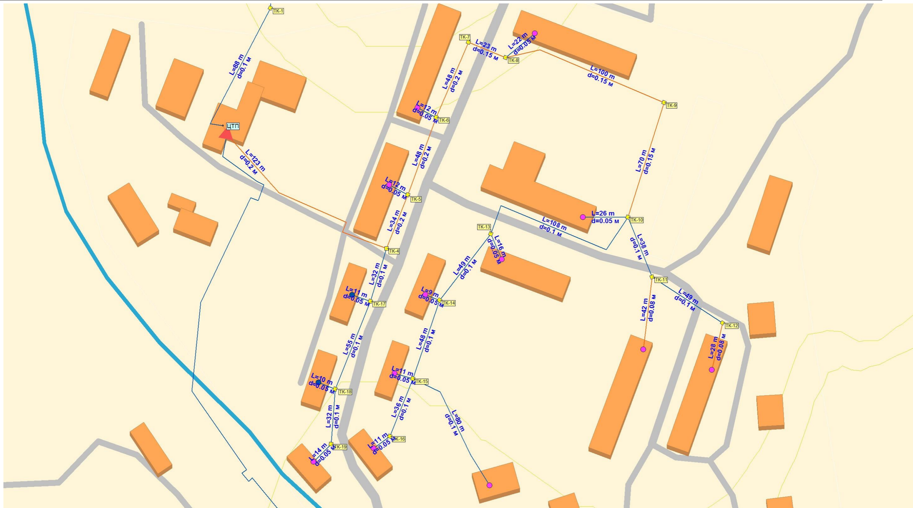
Рисунок 5.4.1. Графическое изображение участков тепловых сетей, подлежащих смене диаметра (мазутная котельная)
